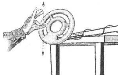
b. Поисковая катушка должна быть вдалеке от стен, пола и металлических предметов.
