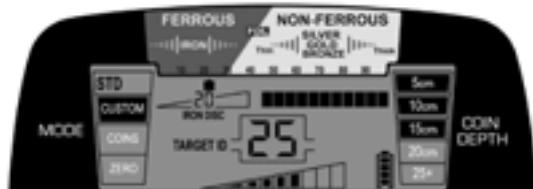
На этом рисунке *AT Pro* работает с уровнем IRON DISC, равным 20. Гвоздь, показанный на рисунке 1 (на стр. 22) даёт отметку на шкале Цифровой отметки объекта в диапазоне от 10 до 25. Чтобы исключить гвоздь из числа обнаруживаемых объектов, кнопкой IRON DISC (+)увеличьте уровень дискриминации железа до 25 То.
