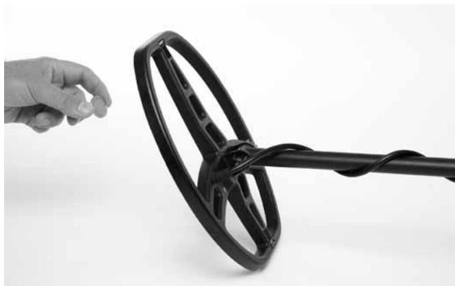
Для стеновой проверки поместите катушку на плоскую устойчивую неметаллическую поверхность, находящуюся на расстоянии нескольких футов (1-1,5 м) от прочих металлических предметов.
