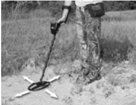
**Примечание:** Для достижения наилучших результатов при использовании способа точной локализации сохраняйте постоянной высоту катушки над поверхностью земли (например, 2 см) и проверяйте, что металлоискатель правильно отстроен от грунта.
