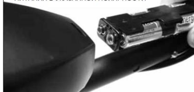
ВСТАВИТЬ ДЕРЖАТЕЛЬ ЭЛЕМЕНТОВ ПИТАНИЯ В УКАЗАННОЙ ПОЛЯРНОСТИ
