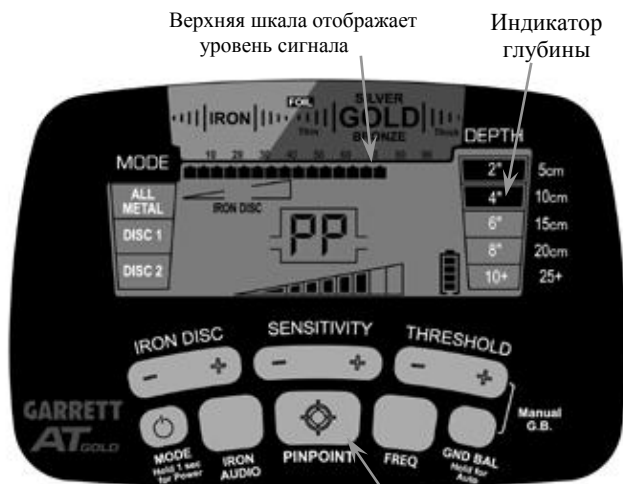
Кнопка PINPOINT (Нажать, удерживая, для точной локализации)
